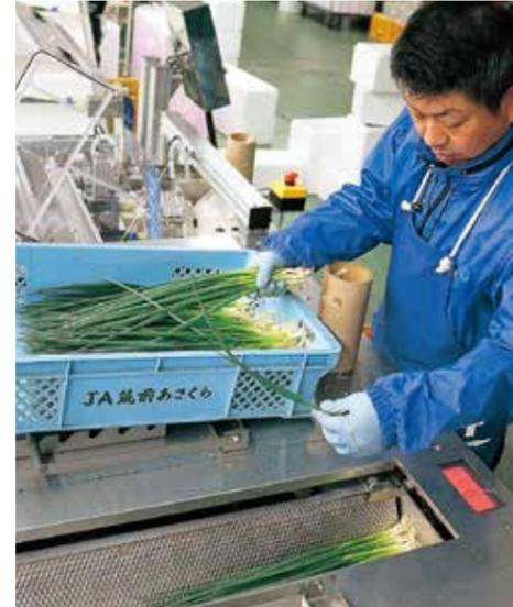
◇簡易計量結束機の導入で処理能力の向上を図る
