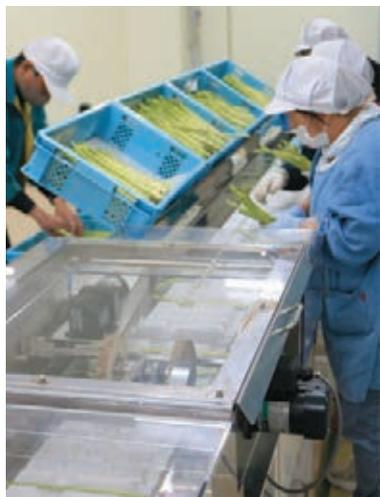
◇ 順調に稼働するアスパラガスの計量選別機
